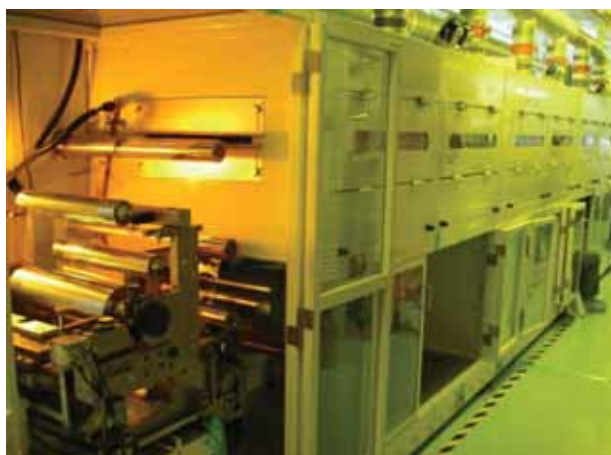
小塗布機的塗布狀況及外觀 上圖是小型塗布機進行塗布的狀況，白色是塗層。下圖是塗布機全觀，長約 10 公尺，寬約 60 公分。
