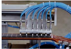
圖.4 自動吉他壓弦機構
