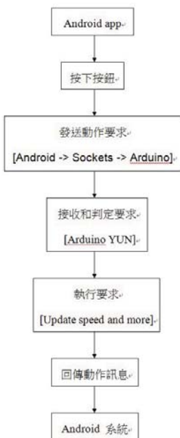
圖 2.8 車體運動控制之執行流程
