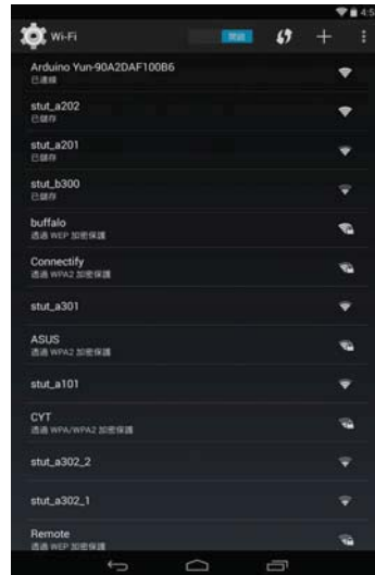
圖 2.4 Android 手機與 Arduino YUN 板的 Wi-Fi 連接
