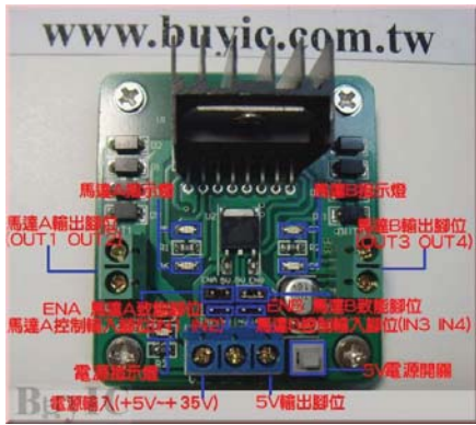
圖 2.6 L298N 馬達控制電路模組
