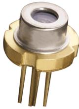
雷射二極體或稱半導體雷射是一種雷射產生器，其工作物質是半導體，屬於固體雷射產生器，大部份雷射二極體在結構上與一般二極體相似。具有體積小、耗電少、反應快、耐衝撞、壽命長、效率高及價格低等優點，於光電系統產品中應用範圍十分廣泛。
