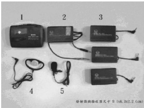
圖6. 學校團體所使用的語音導覽器材包括：(1) 錄音機 (2) 發射器 (3) 接收器 (4) 耳機 (5) 麥克風。(筆者攝於故宮)
